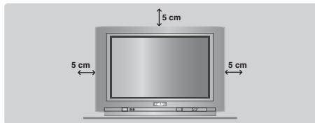
Mettere il televisore su una superficie solida e stabile, lasciando uno spazio di almeno 5 cm attorno all'apparecchio. Per evitare situazioni pericolose, non posare nulla sul televisore, e soprattutto nè oggetti coprenti (centrini), o contenenti sostanze liquide (vaso) o irradianti calore (lampada). Verificare inoltre che il televisore non venga esposto ad eventuali schizzi d'acqua.
