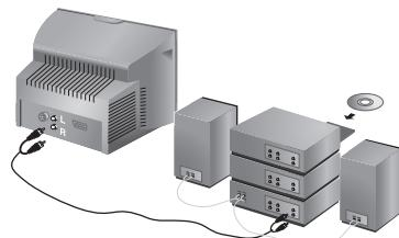
Per il collegamento ad un sistema hi-fi, utilizzare un cordone di collegamento audio e collegare le uscite "L" e "R" del televisore (disponibile solo su determinate versioni) agli ingressi "AUDIO IN" "L" e "R" del vostro amplificatore hi-fi.
