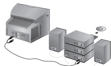
Για σύνδεση σε στερεοφωνικό συγκρότημα, χρησιμοποιήστε ένα καλώδιο ψηφιακής σύνδεσης ήχου και συνδέστε τις εξόδους "L" και "R" της τηλεόρασης (υπάρχει μόνο σε μερικές εκδόσεις) με την είσοδο "AUDIO IN" "L" και "R" του ενισχυτή του στερεοφωνικού σας συγκροτήματος.
