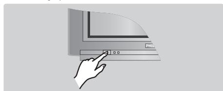
Για να ανάψετε την τηλεόραση, πίεστε το κουμπί λειτουργίας/διακοπής (ON/OFF). Τότε ανάβει μια κόκκινη λυχνία και φωτίζεται η οθόνη. Διαβάστε αμέσως το κεφάλαιο Γρίγορη εγκατάσταση στην επόμενη σελίδα. Αν η τηλεόραση βρίσκεται σε κατάσταση αναμονής, πίεστε το πλήκτρο P (+) του τηλεχειριστηρίου. Η λυχνία αναβοσβήνει όταν χρησιμοποιείτε το τηλεχειριστήριο.
