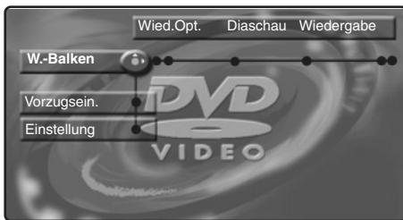
Mit diesem Menü können Sie auf alle Spezialfunktionen des DVD-Players zugreifen. Drücken Sie die Taste **(+)** (SYSTEM MENU). Das Menü wird am Bildschirm angezeigt. Mit den Tasten **<>^v** können Sie sich innerhalb der verschiedenen Menüs bewegen und Einstellungen vornehmen. Zum Verlassen der Menüs drücken Sie erneut die Taste **(+)** (SYSTEM MENU). Wenn die Funktion auf der Disk bei der Wiedergabe nicht verfügbar ist, wird der Text grau angezeigt.
