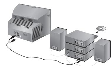
Zum Anschluß an eine Hifi-Anlage benutzen Sie ein Audio-Verbindungskabel. Verbinden Sie die Anschlüsse "L" und "R" des Fernsehgerätes (nur bei einigen Modellen verfügbar) mit einem Eingang "AUDIO IN" "L" und "R" des Verstärkers. Verwenden Sie ein digitales Audio-Verbindungskabel und schließen Sie den Ausgang "DIGITAL AUDIO OUT" des Fernsehgerätes an einen "DIG IN-Eingang" des Verstärkers an (Verstärker mit digitalem Koaxialeingang).
